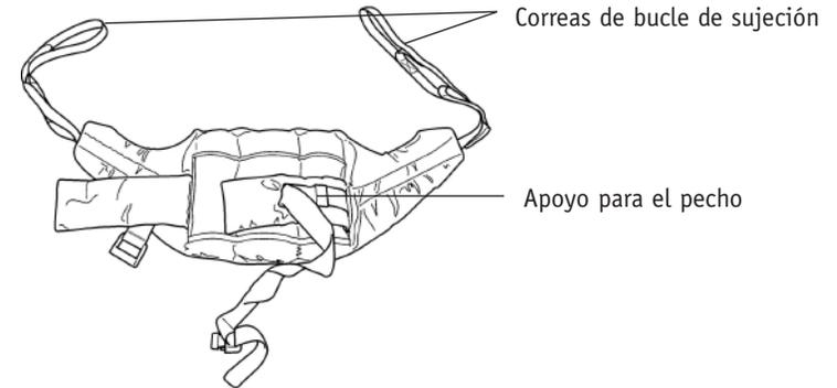
Coloque la eslinga por debajo de la espalda del paciente entre la base de las escápulas del hombro y la parte inferior de las costillas. Sujete las correas de apoyo alrededor de la parte delantera del paciente. Esta correa no tiene que quedar apretada. Su función consiste en sujetar la eslinga en su posición mientras se sujeta la eslinga al Standaid. Puede dejarse sin abrochar si se prefiere. Asegúrese de que los brazos del paciente queden en la parte exterior de la eslinga.
