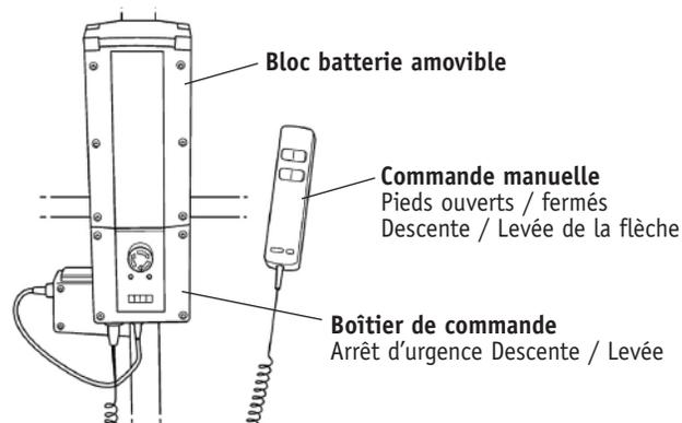
Lorsque le bloc d'alimentation doit être rechargé, retirez-le du lève-personne et branchez-le sur le chargeur autonome.
