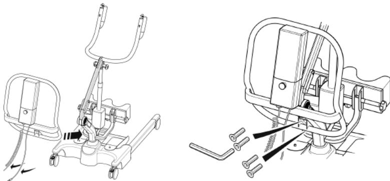
6. Setzen Sie die Akkueinheit in den Lifter ein und vergewissern Sie sich, dass der Verschluss, der die Einheit an ihrem Platz hält, vollständig eingerastet ist. Die Einheit muss mit einem klickenden Geräusch einrasten.
