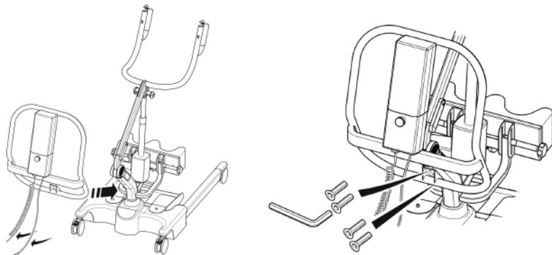
6. Remplacez le bloc d'alimentation sur le lève-personne et vérifiez que la bride le maintenant est totalement enclenchée. Enclenchez le bloc.
